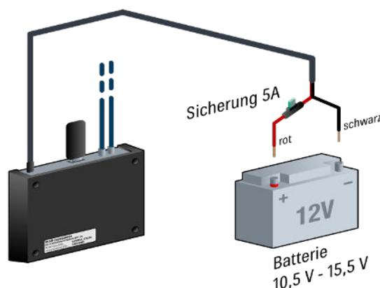
Der CAP-Konverter soll über eine 5 A Sicherung abgesichert werden. Diese ist zwischen dem roten Anschlusskabel und der Batterie zu schalten.
